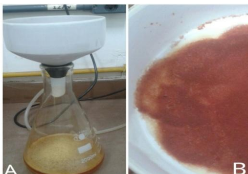
Figura 2: Filtração a vácuo (A) e material filtrado utilizado nas análises (B).
